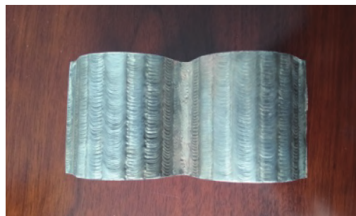
图 19 使用激光熔敷技术处理后的水冷壁管 [6]
