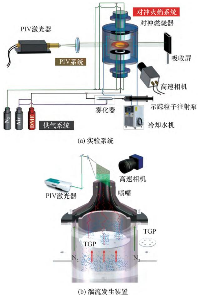
图1 对冲火焰实验系统与湍流发生装置
