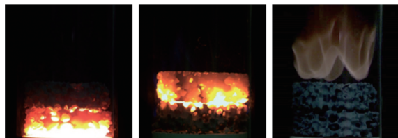
图 5 多孔介质燃烧状态: 低流速浸没燃烧 (左), 高流速浸没燃烧 (中), 吹出 (右)(图示为掺氨甲烷多孔介质燃烧的吹出过程, 本文的模拟和实验都采用纯甲烷作为燃料)
