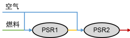
图 1 RQL 燃烧的 CRN 概念模型
